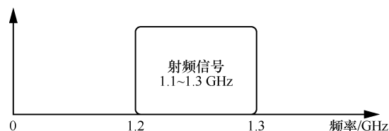
图 7 中心频点为 1.2 GHz 的 200 MHz G.hn 应用的频谱
